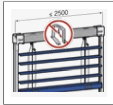
Construction de stores autoporteuse
