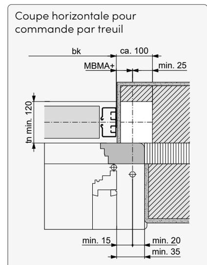
**hg** Hauteur réservation manoeuvre    **MBMA** Dimension jusqu'au centre de la commande
